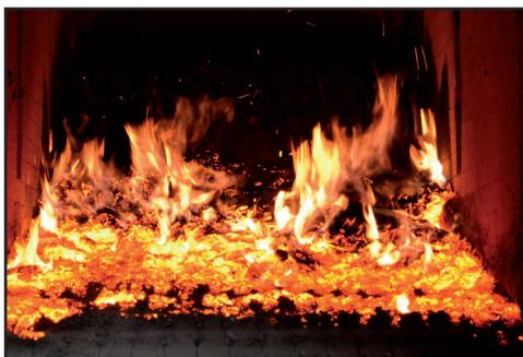
drvna sečka automatski doprema do keramičko-linijske komore za sagorevanje, pužnim mehanizmom ili uređajem sa hidrauličnim klipom.
