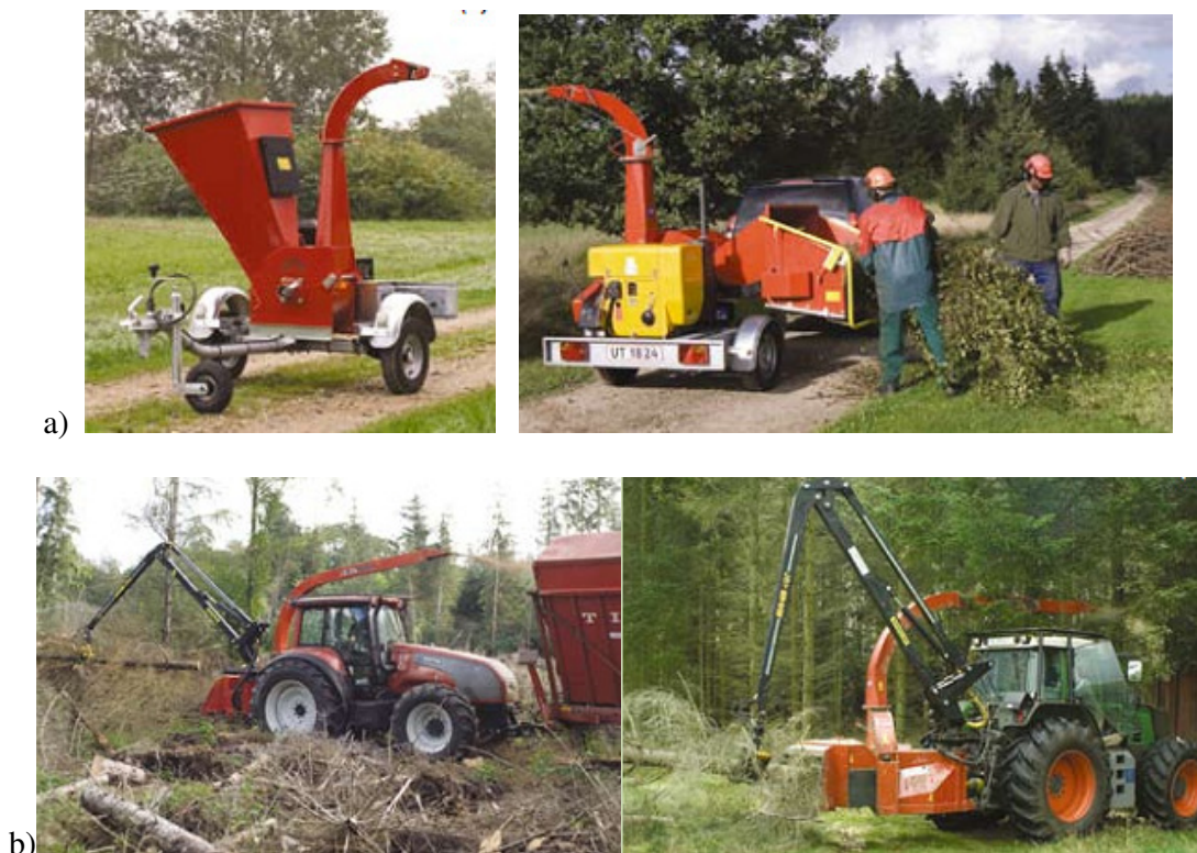
Slika 6.1 Mašine za pravljenje sečke (www.linddana.dk)
