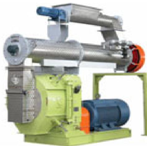
Slika 8.3 Primer male pelet mašine kapaciteta 300 kg/h
