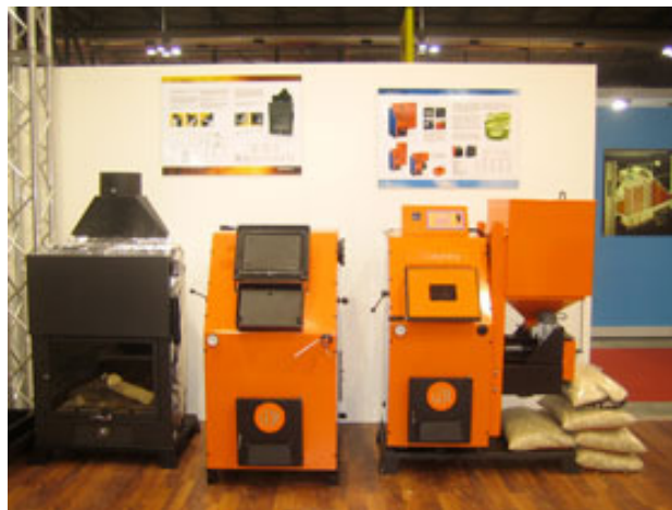
Slika 6.3 Kotao sa bunkerom i sistemom za doziranje za sagorevanje peleta ( www.termomont.co.yu )
